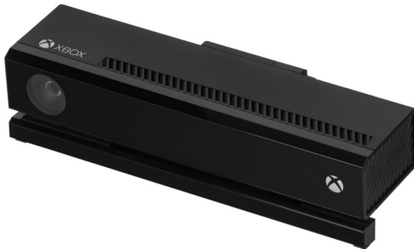
Abbildung 2.7: Kamera der Microsoft Kinect V2 [3]
