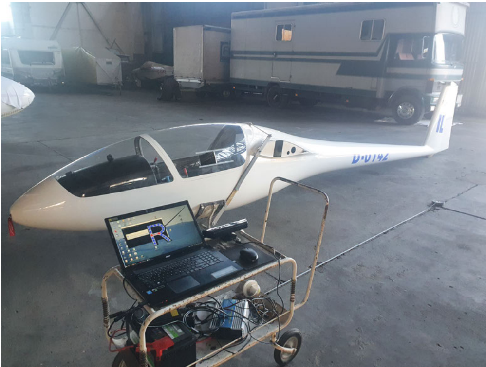
Abbildung 3.1: Aufbau für die Erfassung mit der Microsoft Kinect V1
