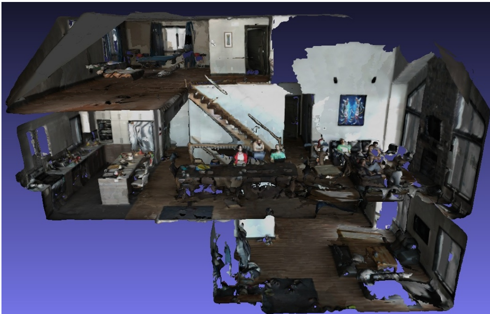
Abbildung 2.13: Mit "RTAB-Map" erstellte Karte eines mehrstöckigen Hauses [24]
