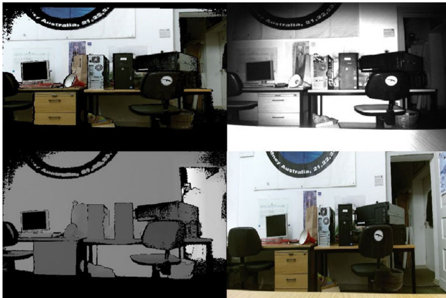
Abbildung 2.9: Von der Microsoft Kinect V2 erzeugte Bilder - Bildschirmaufnahme von "Protoectäus" libfreenect2"
