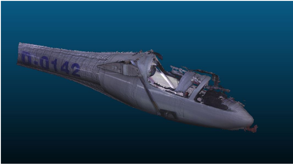
Abbildung 4.1: Rekonstruktion der rechte Seite des Segelflugzeugrumpfes mit "ReconstructMe"
