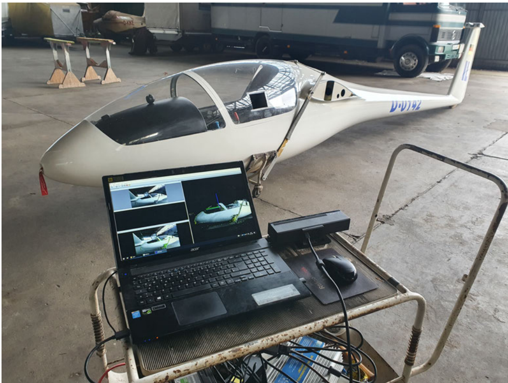
Abbildung 3.2: Aufbau für die Erfassung mit der Microsoft Kinect V2 und die Modellierung mit "RTAB-Map"
