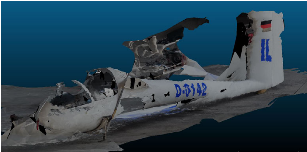
Abbildung 4.16: Mit "Meshroom" erzeugtes Mesh aus sinusförmiger Erfassung der linken Hälfte des Segelflugzeugrumpfes
