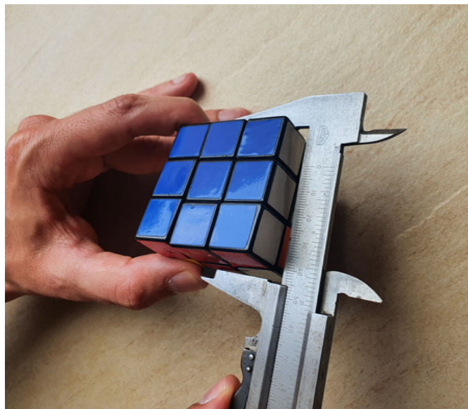
Abbildung 2.1: Händische Vermessung eines Zauberwürfels mittels Messschieber
