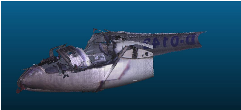
Abbildung 4.2: Rekonstruktion beider Seiten des Segelflugzeugrumpfes mit "ReconstructMe"
