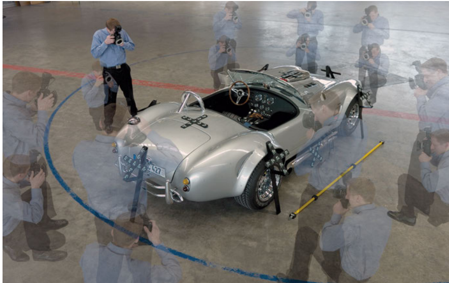
Abbildung 2.4: Darstellung des Prinzips der Photogrammetrie [23]
