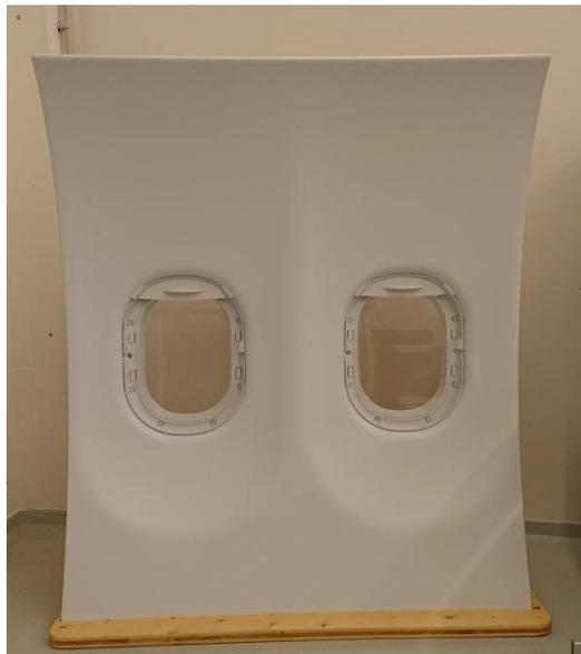
Abbildung 3.2: Vorderseite eines Seitenwandpanels ohne Dadopanel
