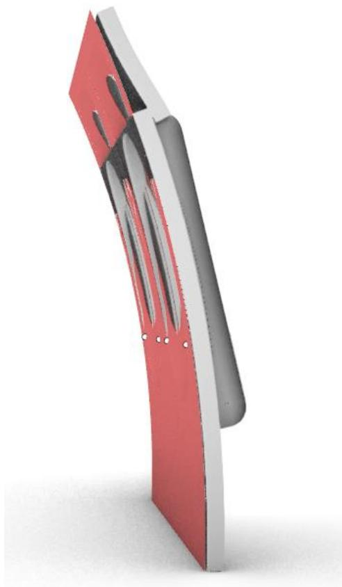
Abbildung 5.5: A350-Seitenwand-Modell und erzeugtes Modell übereinander
