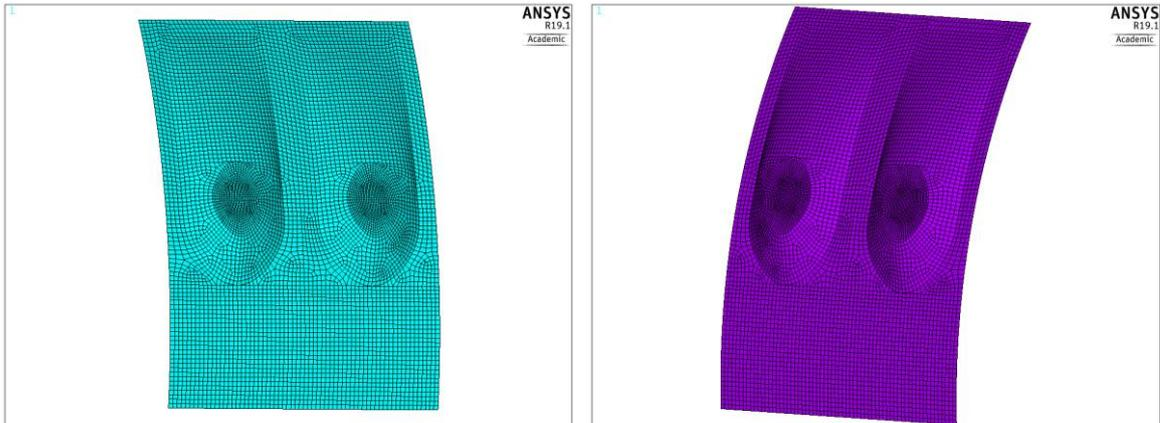
Abbildung 3.3: FEM-Modelle der Seitenwand, Links: Außenseite; Rechts: Innenseite
