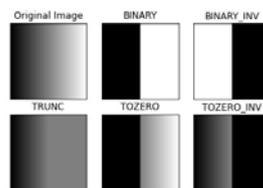
Abbildung 5.7: Threshold Varianten (aus [29])
