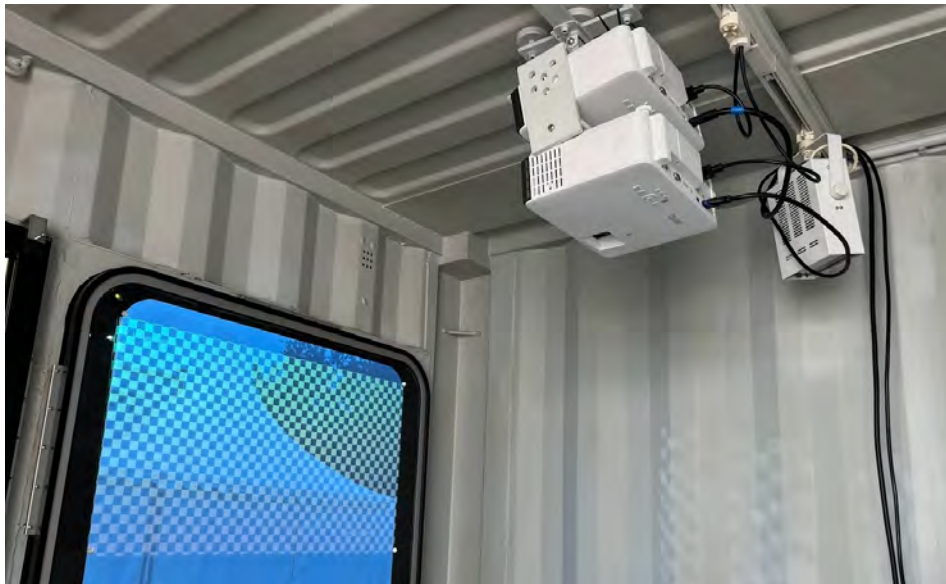
Abbildung 4.3: Das entwickelte doppelte Projektor-Setup mit übereinanderliegendem Output auf gedimmter Scheibe. Die grünliche Färbung ist ein Artefakt der aufnehmenden Kamera.
