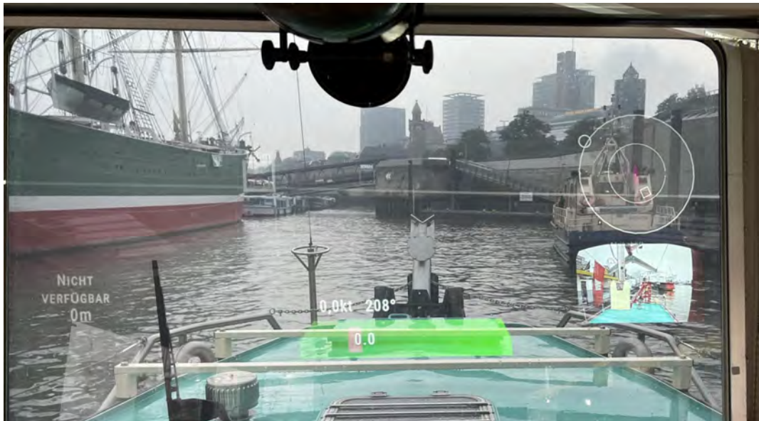
Abbildung 4.14: Blick durch das Smart Window im Kalibriermodus, zu sehen die grüne Box, dahinter die passend die Zugangsluke sowie mittig im Bild die Horizontlinie
