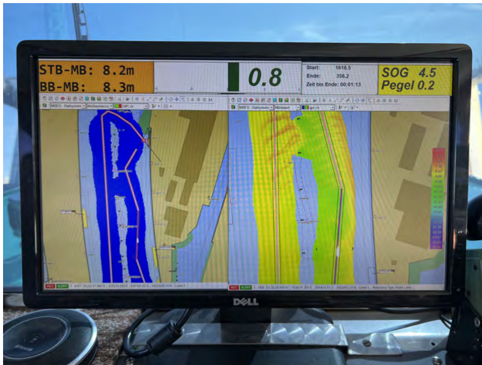
Abbildung 4.12: Navigationsmonitor des Deepenschwrier 3 während einer Peilfahrt. Zu sehen sind zentral die zu verfolgende Route in zwei verschiedenen Maßstäben, oben mittig aktuell 0.8m Abweichung von der Route nach Steuerbord (Grün), rechts der Speed over Ground (SOG)
