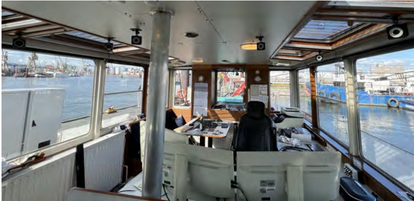
(a) Optitrack-Array mit insgesamt 6 Kameras (unverkabelt)
