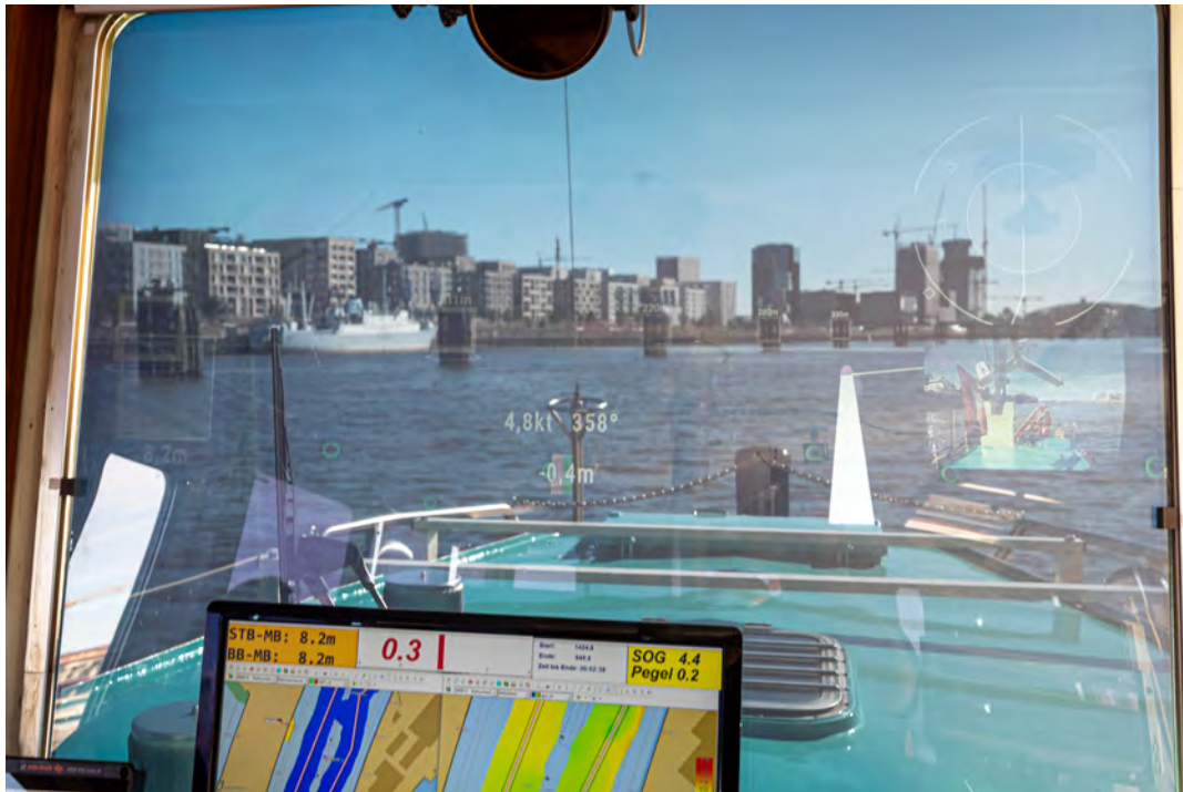
Abbildung 4.13: Das für den Probandenversuch entwickelte UI im Einsatz. Zu sehen (im Uhrzeigersinn) Übersichtskarte mit Peillinie und Entfernungsringsen, Videobild der Rückkamera, Abweichung von der aktuellen Peillinie (0.4m nach Backbord), Kurs, Geschwindigkeit und Verlauf der Wassertiefe. Zu sehende weltrelative Inhalte die Peillinie mit Verdeckung durch das Vorschiff sowie (schwach) Entfernungsmarkierungen auf umgebender Unfrastruktur.
