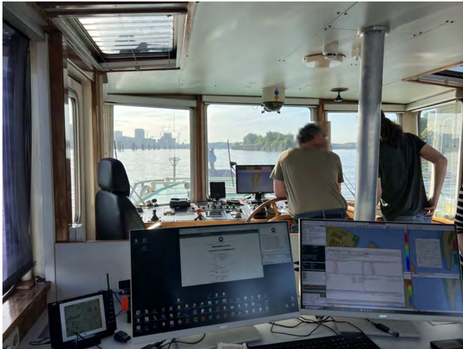
Abbildung 1.4: Die Brücke des Peilschiffs „Deepenschriewer 3“. Im Vordergrund der Arbeitsplatz des Hydrographen, im Hintergrund Schiffsführer mit Kontrollmonitor und Steuerrad
