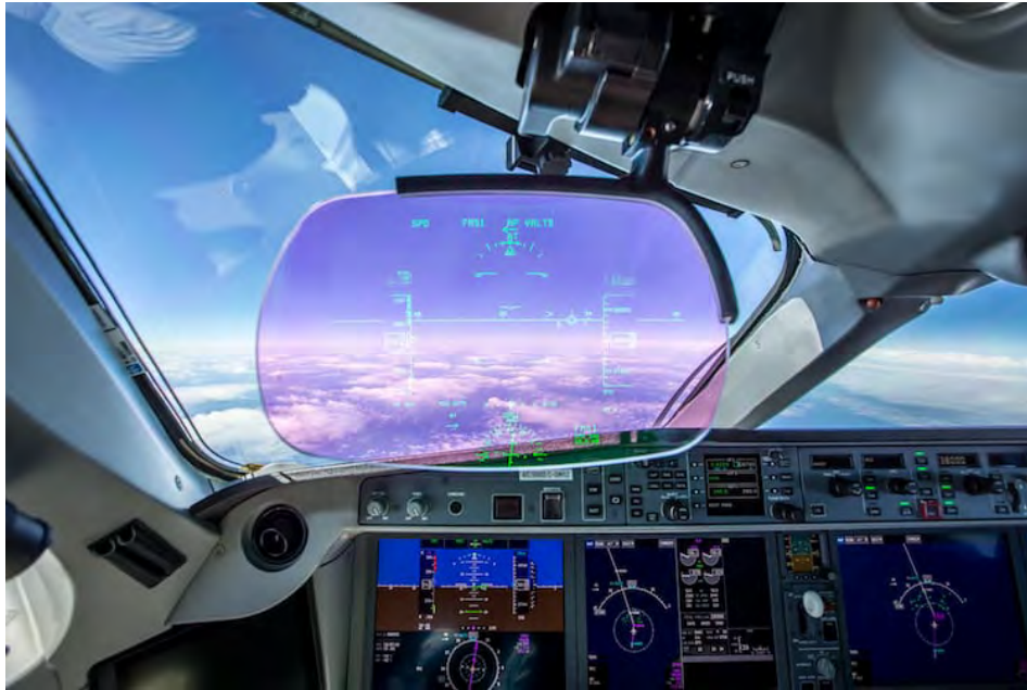
Abbildung 2.2: Head-Up-Display im Airbus A220, der Projektor ist in diesem Fall hinter den Piloten an der Cockpit-Decke angebracht (Quelle: Woodrow, B., 2018)
