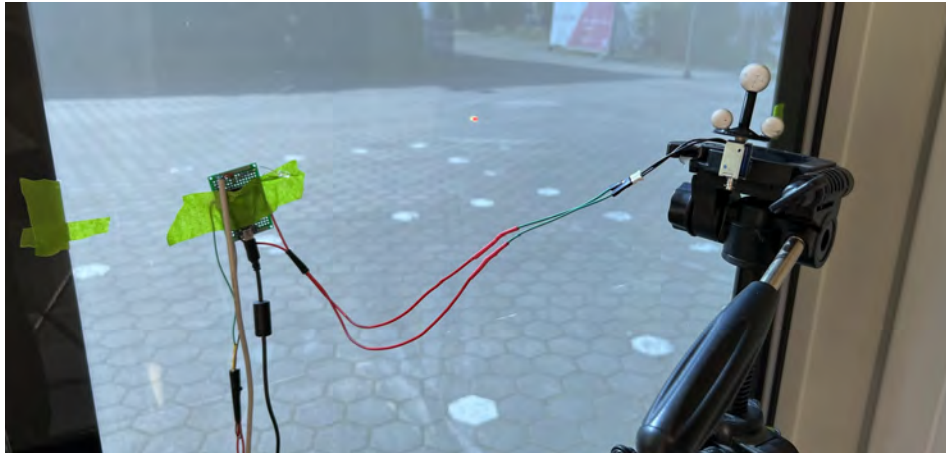
Abbildung 4.4: Der Messaufbau mit konstruiertem Motion-to-Photon Latenztester. Sichtbar die drei Reflektoren des Rigidbody-Markers auf silbernem Solenoid sowie der Mikrocontroller mit Photodiode auf grüner Platine.
