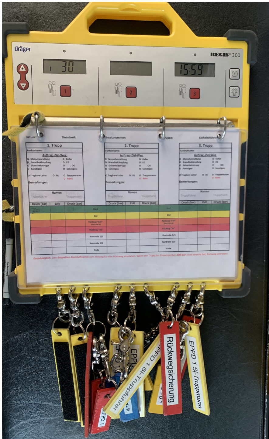
Abbildung 2.2: Analoge Atemschutzüberwachungstafel der Fa. Dräger (REGIS 300)
