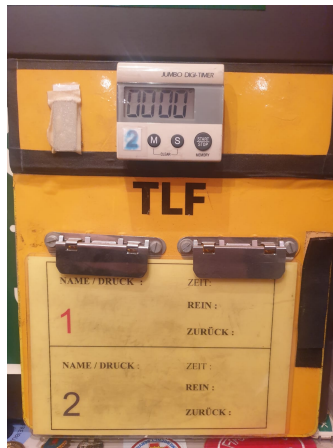
Abbildung 2.1: Analoge Atemschutzüberwachungstafel (Eigenbau)
