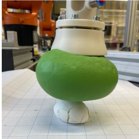
Abbildung 50 Gekochtes Ei von Softgreifer zerdrückt
