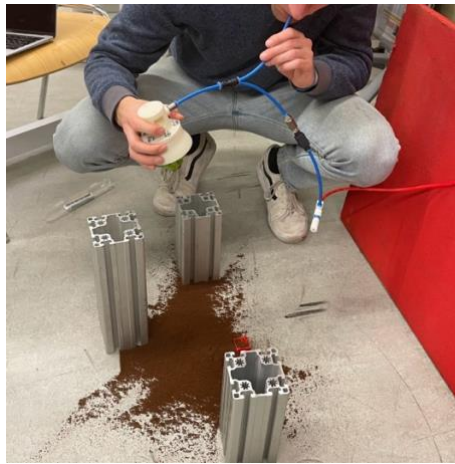
Abbildung 36 Versuch 1.4 - Granulat-befüllter Ballon platzt
