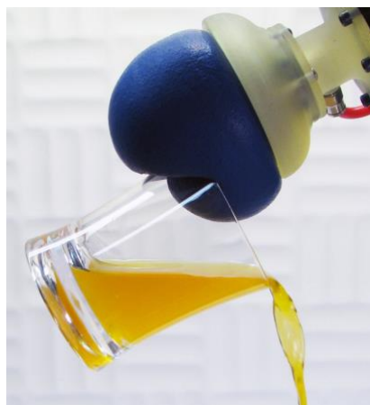
Abbildung 4 Kaffeepulver Ballongreifer – Forschung der Cornell University [6]
