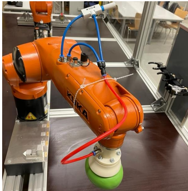
Abbildung 42 Aufbau Versuch 2 - Softgreifer am KUKA Roboter
