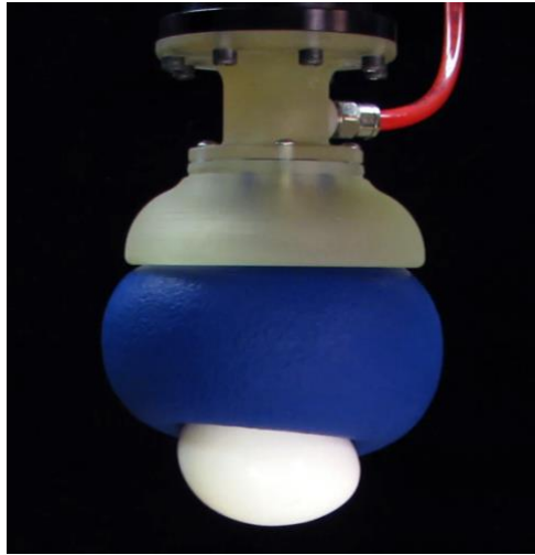
Abbildung 16 Softgreifer von Brown hält ein Ei [6]
