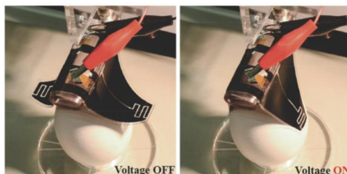
Abbildung 14 Elektrostatischer Softgreifer hebt ein rohes Ei [17]
