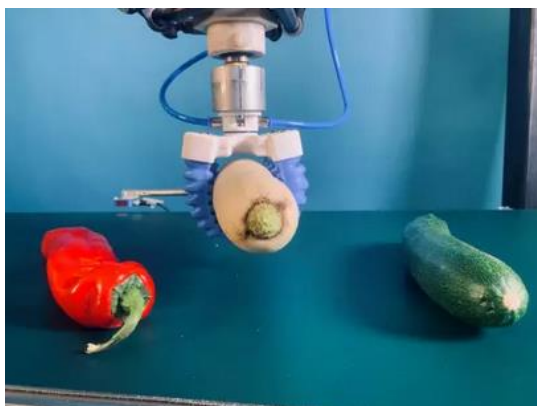
Abbildung 2 Softgreifer von "SoftGripping" [7]
