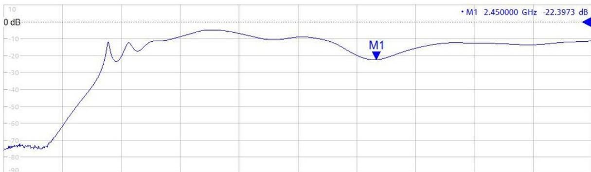
Abbildung 5.12: Der Streuparameter zwischen den rechts übereinander angeordneten Ports
