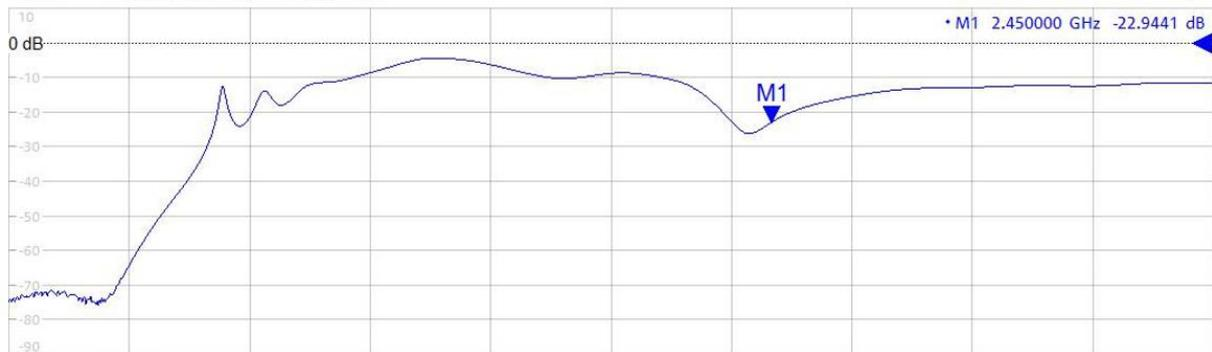
Abbildung 5.11: Der Streuparameter zwischen den links übereinander angeordneten Ports
