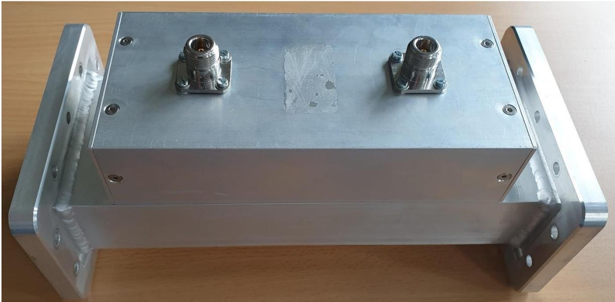
Abbildung 5.13: Der aufgebaute 4.77dB-Koppelfaktor-Combiner
