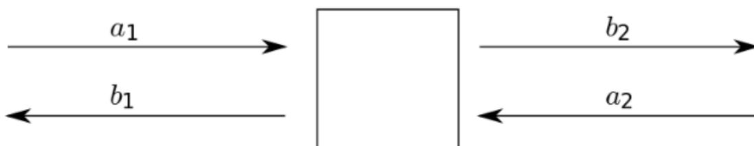
Abbildung 3.1: Ein einfaches 2-Port-Netzwerk
