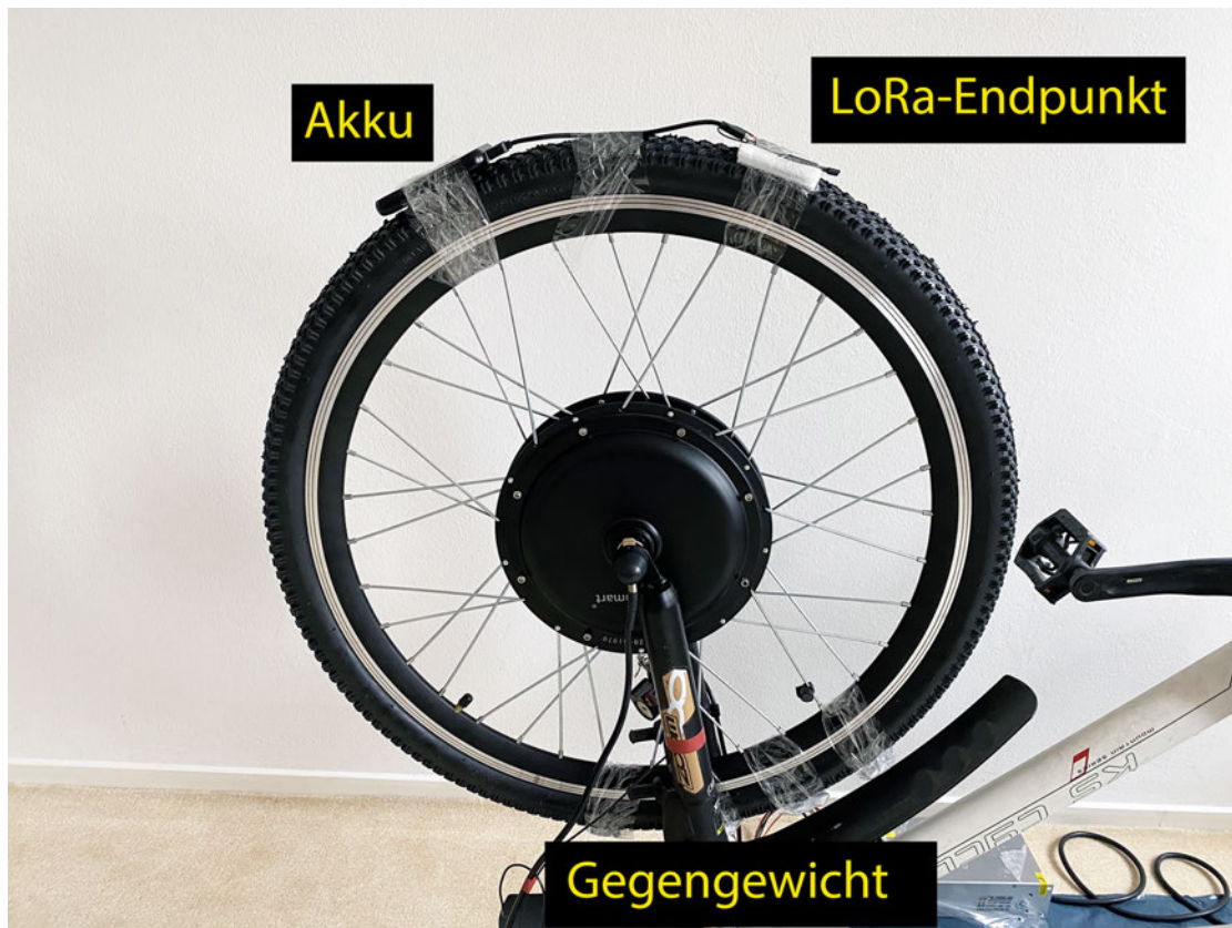
Abbildung 4.5: Darstellung der Montage von Akku, LoRa-Endpunkt und dem Gegengewicht (eigene Darstellung)
