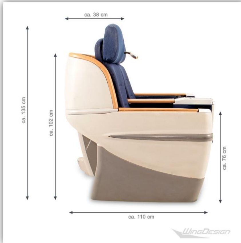
Abbildung 2-10: Business-Class-Sitz mit Abmaßen ("Flugzeugsitz Doppelsitzbank Contour-S20214 Business Class -Lang," n.d.)
