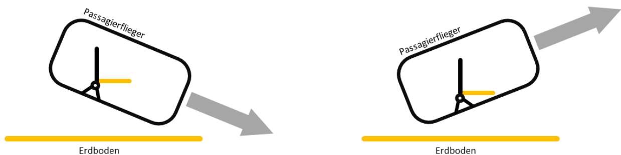
Abbildung 2-9: Prinzipskizze des Orbiters im Steig- und Sinkflug; die Sitzfläche ist jeweils parallel zum Erdboden ausgerichtet (eigene Darstellung)
