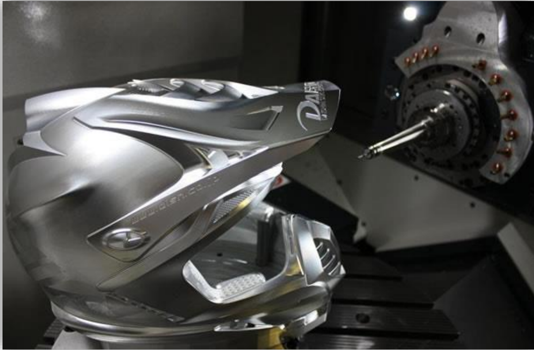
Abbildung 6-1: CNC-gefertigter Motorradhelm aus einem Metallblock. (5Axis Machine Cutting HELMET / DAISHIN SEIKI CORPORATION, 2009)
