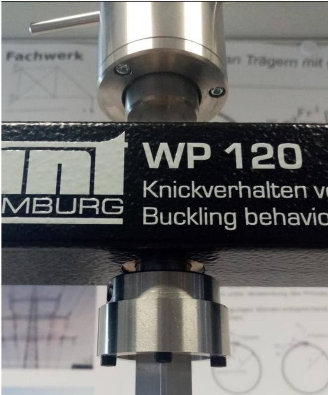
Abbildung 68 Drehvorrichtung zu Kraftaufbringung, Brücke und obere Aufnahme
