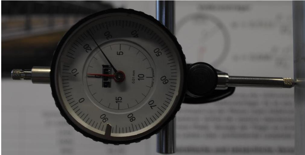
Abbildung 66 Nahaufnahme der Messuhr
