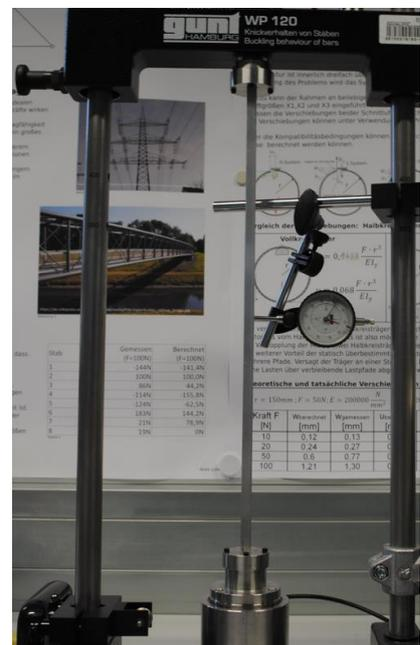
Abbildung 65 Darstellung vom Knickversuch
