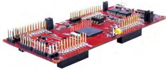
Abbildung 2.1: Entwicklungsplatine mit TMS320F28379D von Texas Instruments
