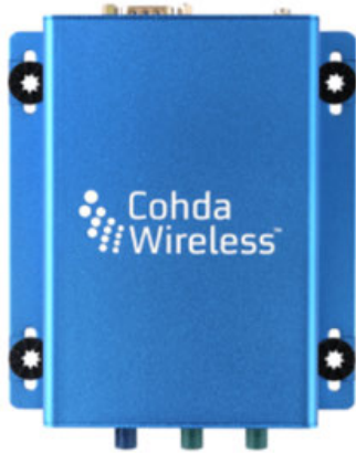
Abbildung 3.5.: Cohda Wireless MK5 Box als On-Board-Unit [7]
