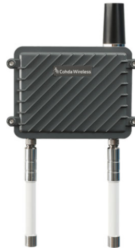
Abbildung 3.6.: Cohda Wireless MK5 als Road-Site-Unit [9]
