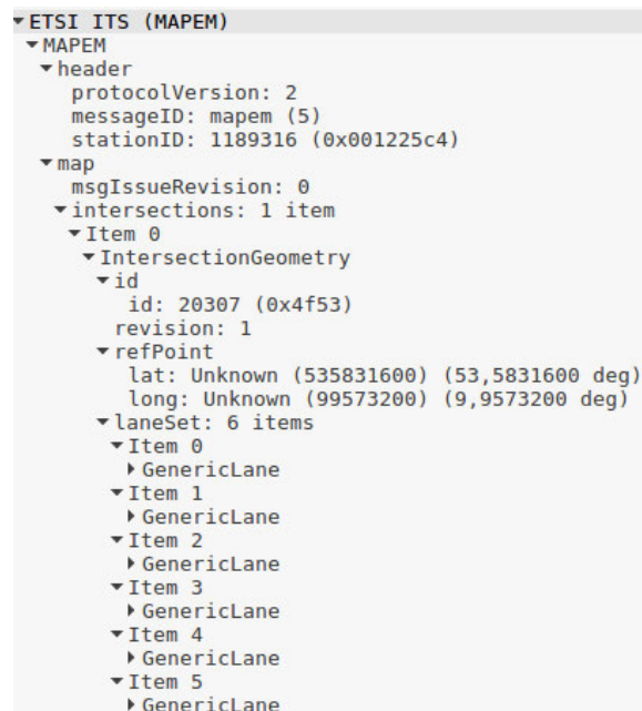
Abbildung 2.11.: Inhalt einer pcap-Datei für die MAPEM; (eigene Abb.)
