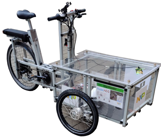
Abbildung 3.2.: Der prototypische Demonstrator: Das autonome und vernetzte Lastenfahrrad
