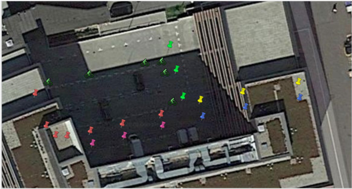
Abbildung 5.8.: Zu sehen ist die kreierte NXP MAP, auf der die Tests gefahren werden. Lanes und Signalgruppen sind definiert und GPS-Marker eingetragen. Die MAP wird in der rsu.cfg der V2X Software hinterlegt.
