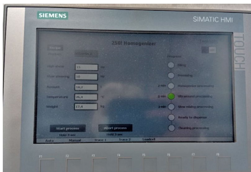
Abbildung 73: Visualisierung des Automatikbetriebes auf dem HMI
