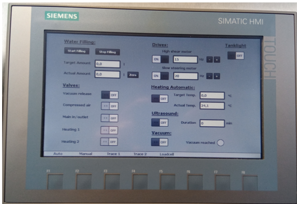
Abbildung 74: Visualisierung des Handbetriebs auf dem HMI
