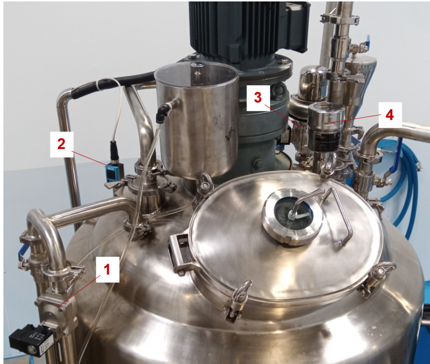
Abbildung 68: Oberer Tankaufbau nach Anbindung
