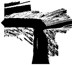
Abbildung 6.10: Costmap vor dem Durchlaufen der Filter Layer.
