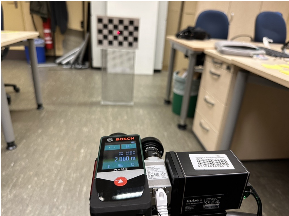
Abbildung 4.2: Bestätigung des Abstands von der Kamera zum Schachbrett durch einen Entfernungsmesser.
