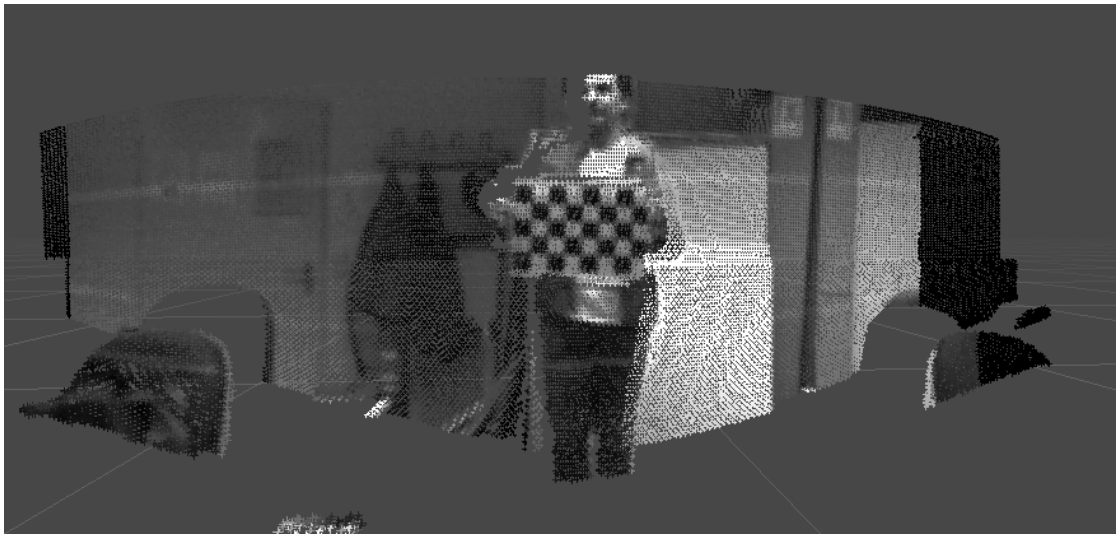
Abbildung 4.15: Ergebnis der Fusion mit der Allied Vision Kamera und der Lidar-Punktvolke im alternativen Versuchsaufbau
