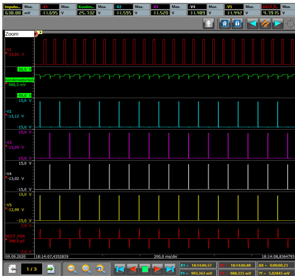
Abbildung 3.24: Impulsübersicht beim bipolaren Impuls
