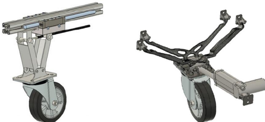
Abbildung 7: links: Hebemechanismus Scherenheber; rechts: Hebemechanismus Hubzylinder
