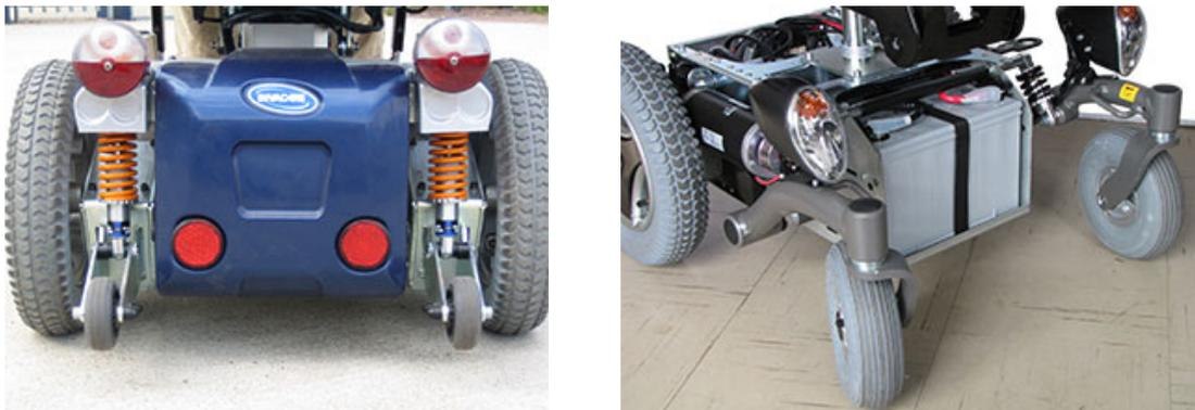
Abbildung 3: Gefederte Antriebsräder (links); gefederte Lenkräder (rechts) [9]
