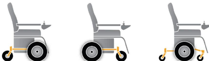
Abbildung 2: Elektrorollstuhl mit: Frontantrieb, Heckantrieb und Mittelradantrieb (von links nach rechts) [10]
