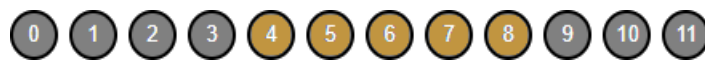
Abbildung 4.11: Beispielhafte Darstellung zum Festlegen der Blinkbereiche. In der Abbildung sind die LED 4 bis 8 markiert. Somit muss in der Konfiguration in led/components/turning_indicator an der korrespondierenden Ecke [4, 8] eingetragen werden. 12
