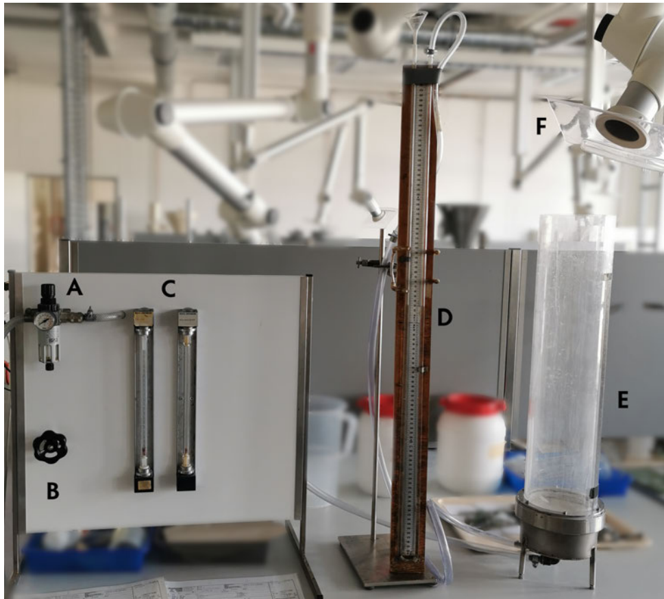
(a) Wirbelschichtversuchsanlage vor den Modifikationen
