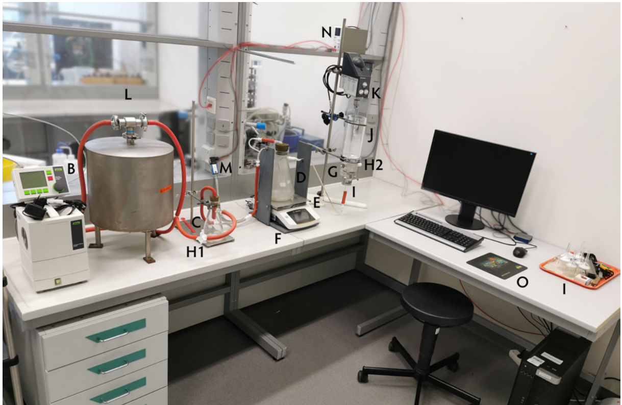
(a) Filterkuchenversuchsanlage nach den Modifikationen
