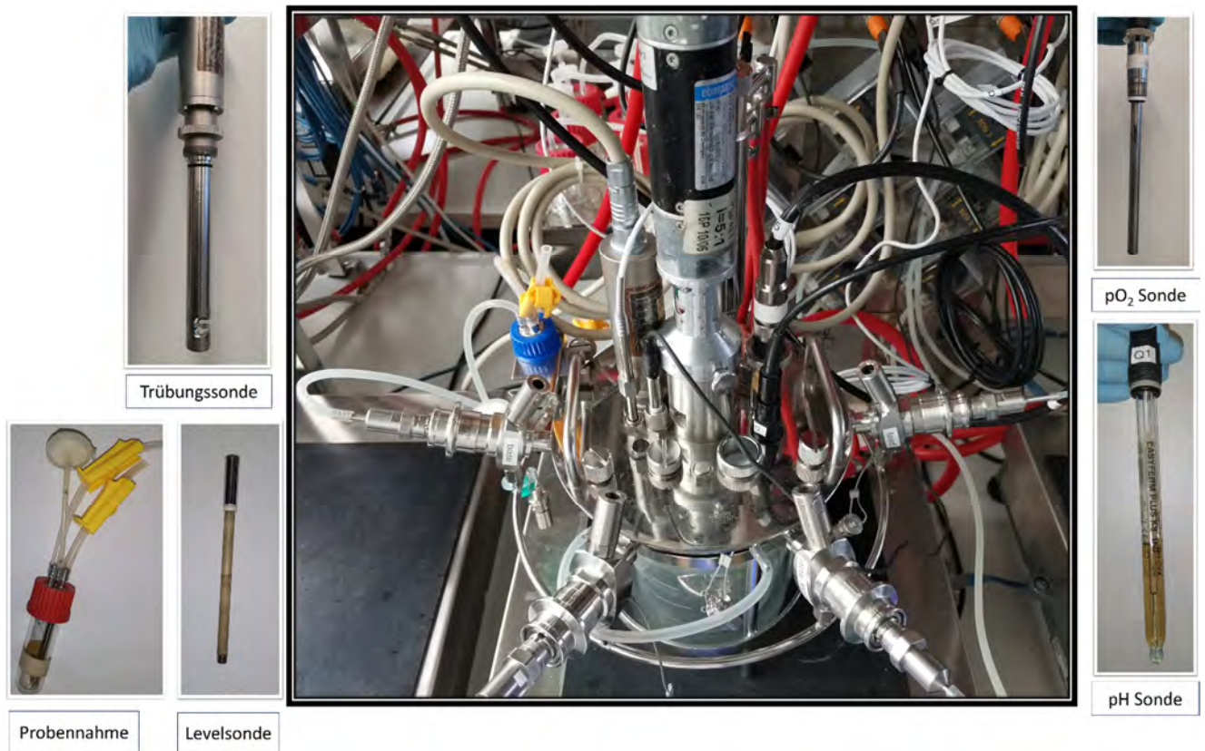
Abbildung 92: BIOSTAT® Qplus mit den entsprechenden Sonden und der Probenentnahmevorrichtung
