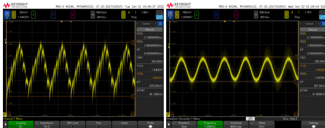
Abbildung 5.4: Eingangssignal des ADC, links ohne und rechts mit Impedanzwandler. f = 1,2 kHz, ADC im 8 Bit-Modus mit F_S = 9,6 kHz
