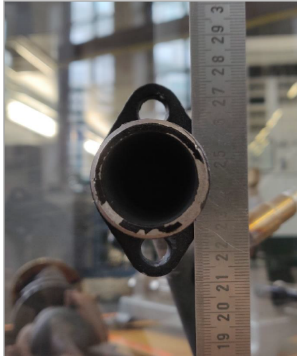
Abbildung 48: Abgasrohr mit Flansch
