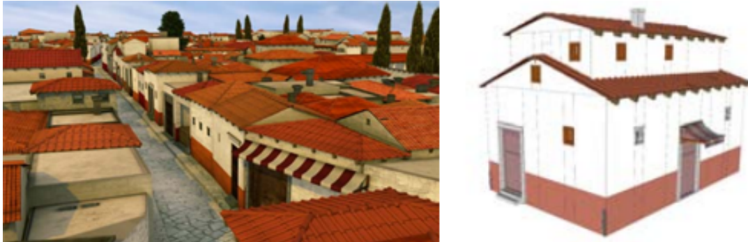
Abbildung 3.2: Beispiele von prozedural generierten Modellen mittels CGA Shape. Links Pompeii, Rechts generisches Gebäude [7].
