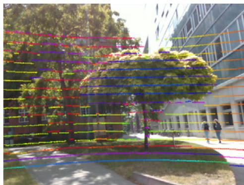
Abbildung 4.1: Early Fusion von Kamera- und Lidardaten.
