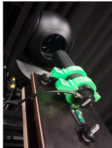
Abbildung 42: Messgerätehalterung vor Ayrton Kyalami; Quelle: Fabian Oving
