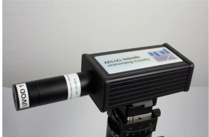
Abbildung 30: JETI Specobs 1211UV mit 100mrad Aufsatz; Quelle: (JETI 2021), S. 1
