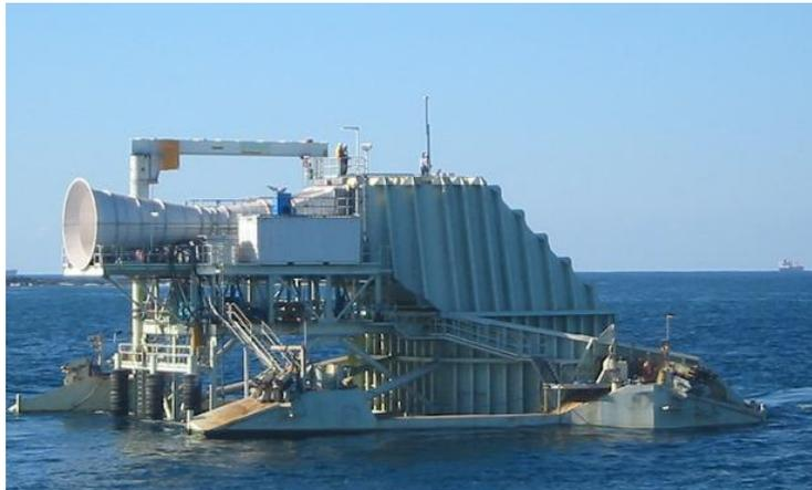
Abbildung 50: Ein schwimmendes OWC-Wellenkraftwerk [63]
