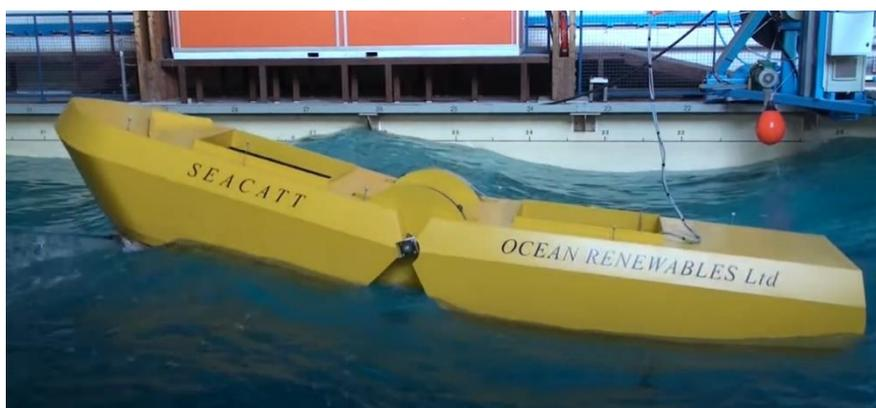
Abbildung 40: Das „Seacatt“- System im Wellenbecken [69]
