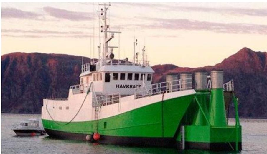
Abbildung 54: Der umgebaute Fischtrawler mit den vier OWC-Kammern am Bug [35]
