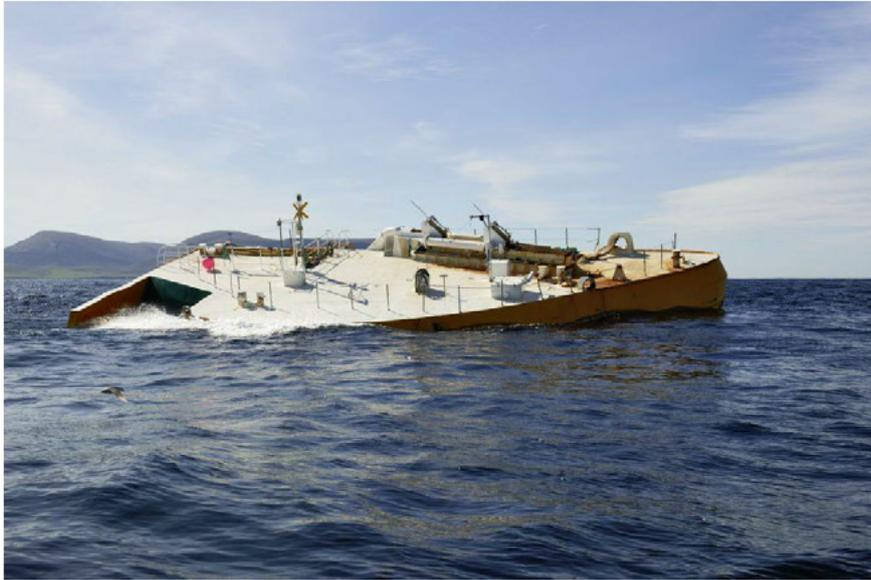
Abbildung 59: Ein „Wello-Pinguin“ im Betrieb. Ansicht auf die breite Rumpfseite [38]
