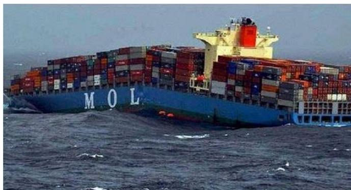
Abbildung 37: Ein Containerschiff mit mittig gebrochenem Rumpf [51]
