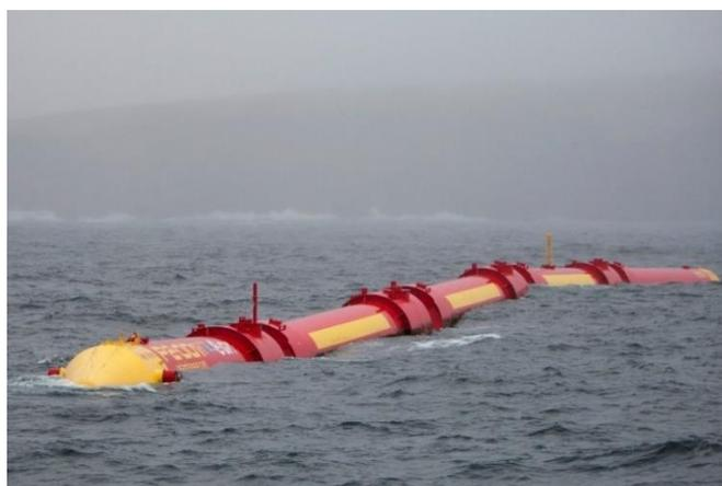
Abbildung 39: Das „Pelamis-System“ im Betrieb [70]
