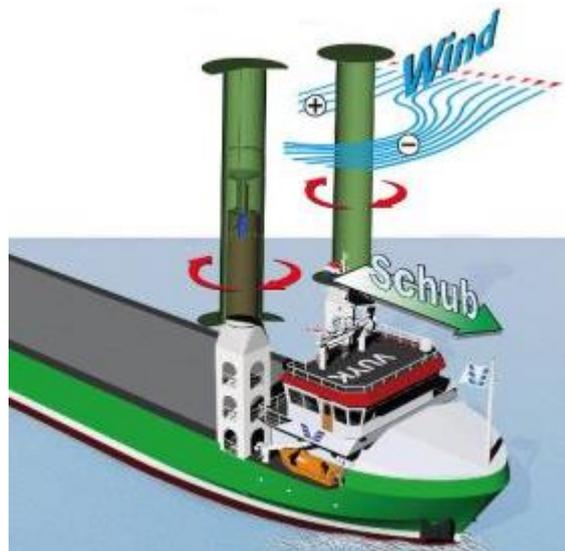
Abbildung 18: Vereinfachte Darstellung der Funktionsweise von Flettnerrotoren auf einem Schiff [60]
