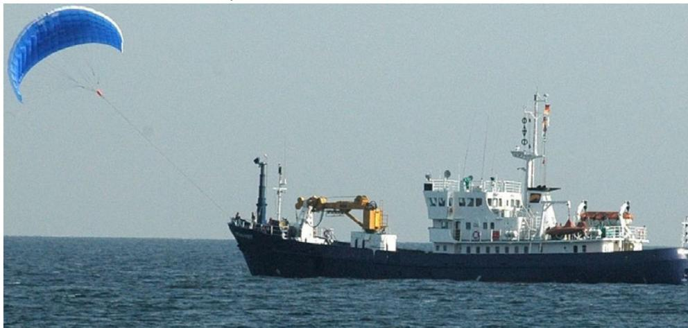
Abbildung 20: Ein Schiff mit Kitedrachen beim Setzen/ Einholen [18]
