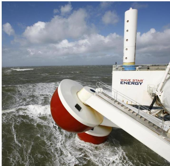
*Abbildung 69: Mit 4m Durchmesser an den Schwimmkörpern, der aktuell größte Prototyp von „Wavestar“ [39]*
