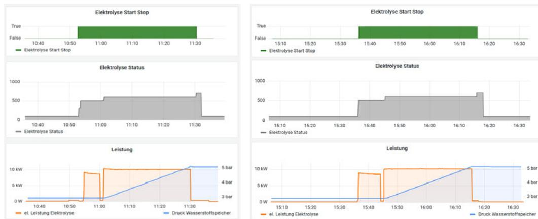
Abbildung 47: Ausschaltvorgänge Elektrolyse
