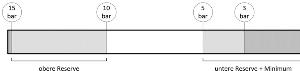
Abbildung 14: Der Wasserstoffspeicher mit seinen Beladegrenzen
