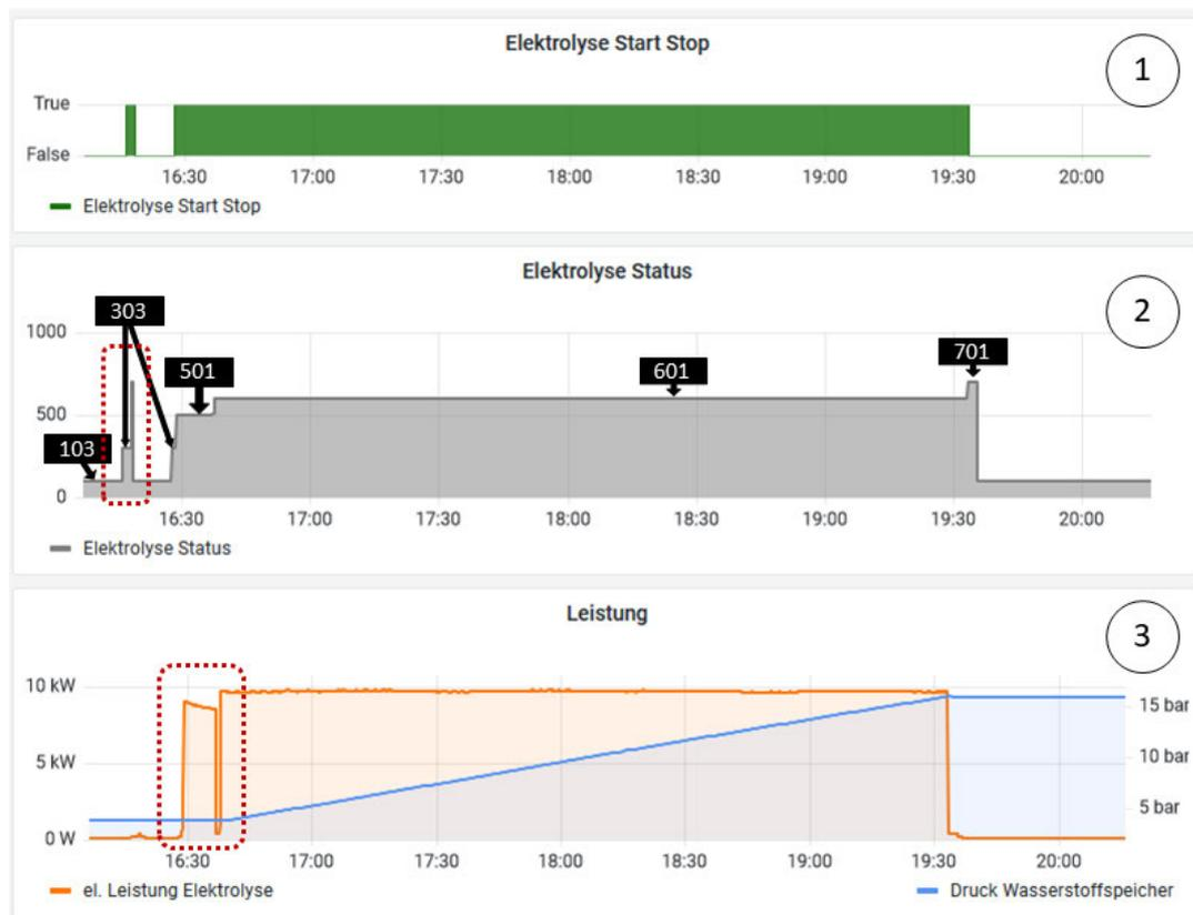
Abbildung 46: Grafana-Screenshot Einschaltverhalten Elektrolyseur
