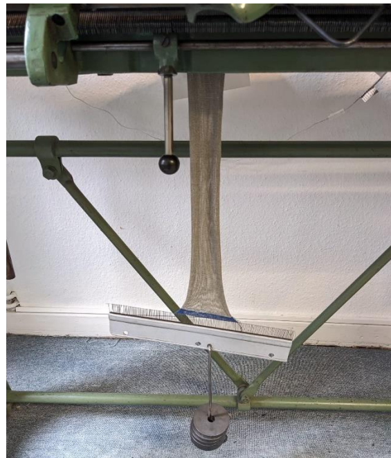
Abbildung 8 Fast fertig gestrickter Armstrumpf mit Gewichten für den optimalen Abzug
