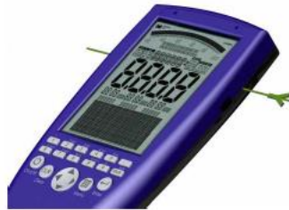
Abbildung 12 in Grün die Position des E-Feld Sensors beim Messgerät Spectran NF 5020
