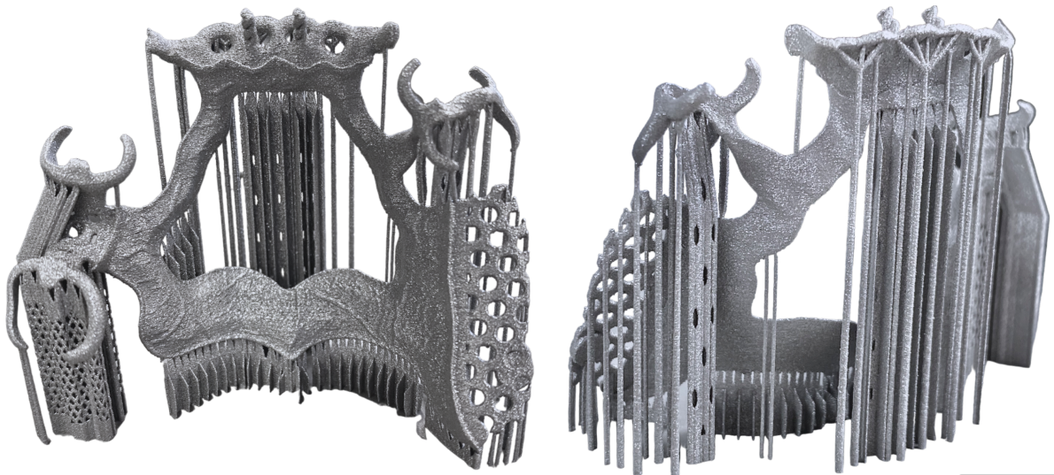
Abbildung 7.2: Modellgussprothese mit optimierten Supports im „as-built“ Zustand.
