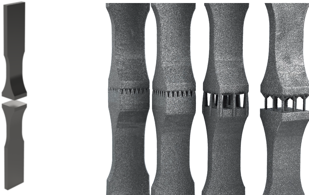
Abbildung 3.4: Geteilte Zugprobe mit Supportverbindungen (Block, Kontur, Kegel, Baum).
