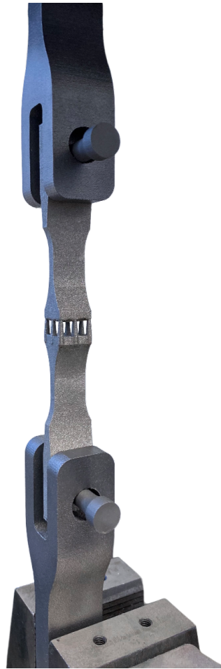
Abbildung 3.6: Versuchsaufbau für Zugproben mit Adapter.
