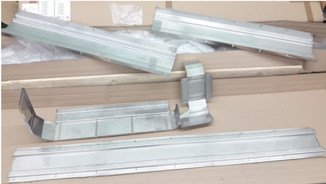
Abbildung 5.9: Bleche für Kabelführung und E-Ketten
