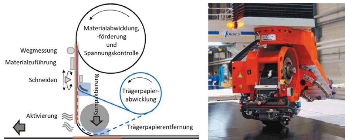
Abbildung 3.3: ATL-Funktionsprinzip (links) und ATL-Ablegekopf von M. Torres Diseños Industriales (rechts) [31]
