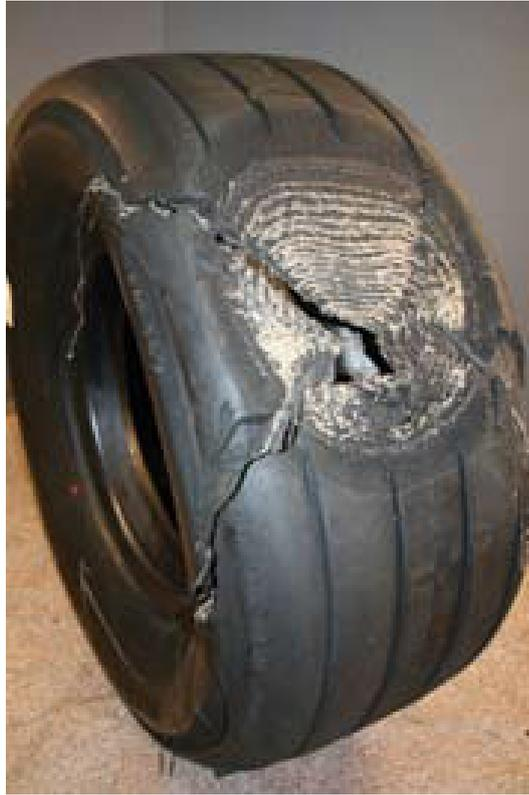
Abbildung 15: Flat Spot mit Reifenbruch [16]
