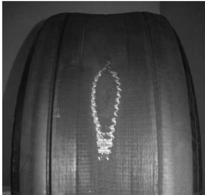
Abbildung 7: Abrieb der Lauffläche[16]
