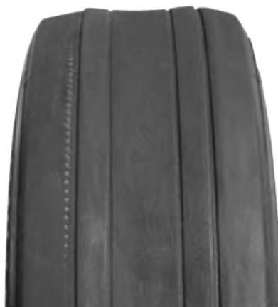
Abbildung 13: ungleichmäßig abgenutzter Reifen [16]
