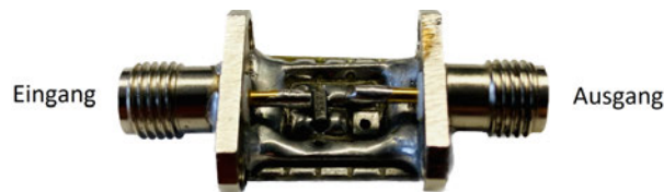
Abbildung 4.11: Platine mit der Schottky-Diode (BAT15-099)
