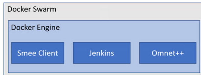
Abbildung 4.2: Diese Abbildung beschreibt die Architektur wie sie auf dem Server eingerichtet wird für das Testverfahren
