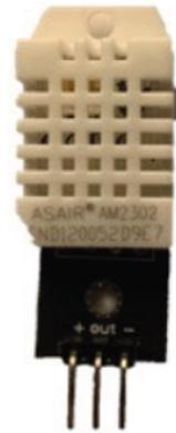
Abbildung 9: Abbildung eines DHT22
