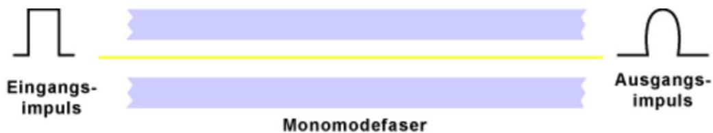
Abbildung 2.4: Lichtverlauf in einer Monomodefaser[1]
