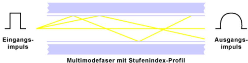
Abbildung 2.2: Lichtverlauf in einer Multimodefaser mit Stufenindexprofil[1]
