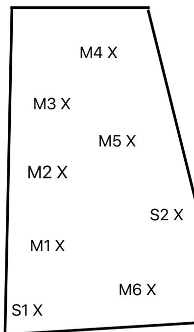
Abbildung 6.1: Messaufbau Absorbermessungen im Hallraum der HAW
