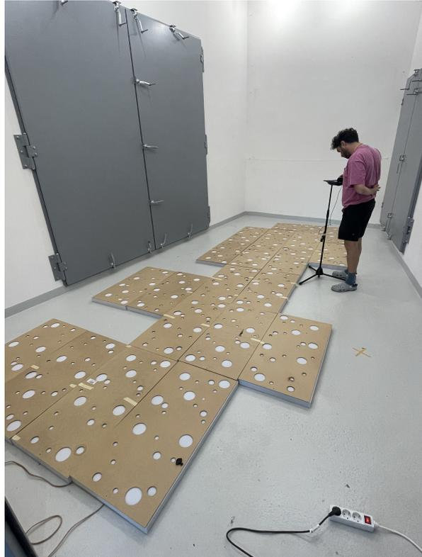
Abbildung 6.3: Durchführung der Messungen für Absorberplatte 1 im Hallraum der HAW
