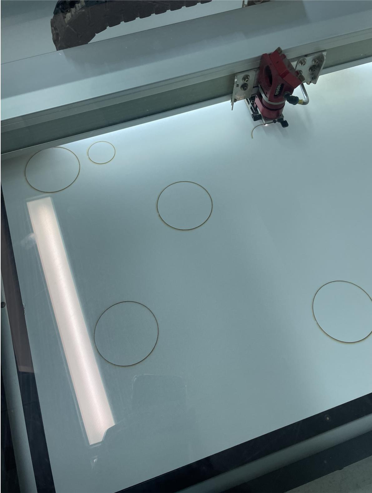
Abbildung 5.3: Produktion der Frontplatten im Lasercutter
