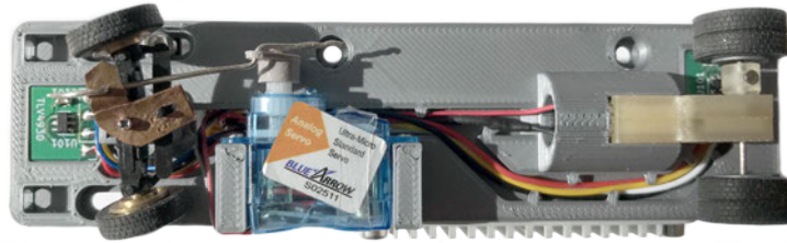
Abbildung 4.6: Auf der Unterseite angebrachtes Servo, mit Umlenkhebel zur Betätigung der Lenkung
