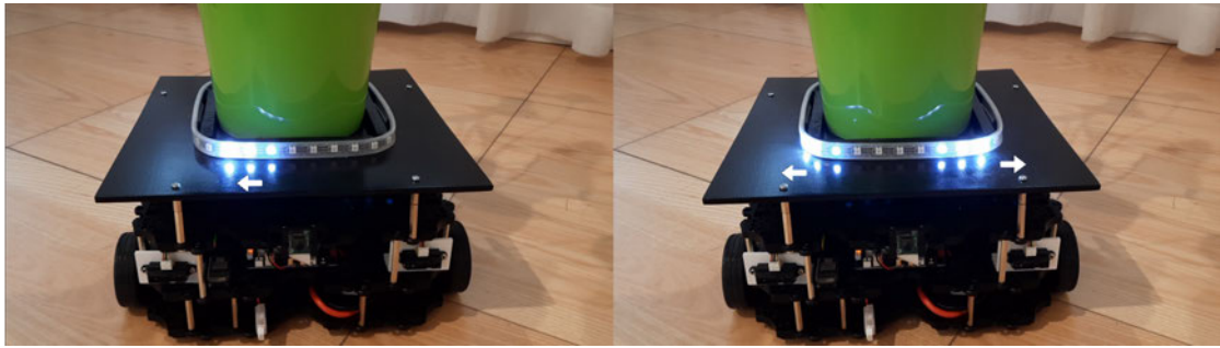
Abbildung 2.3: Links ist das Laufflicht und rechts das geteilte Laufflicht Farbmuster zu sehen.
