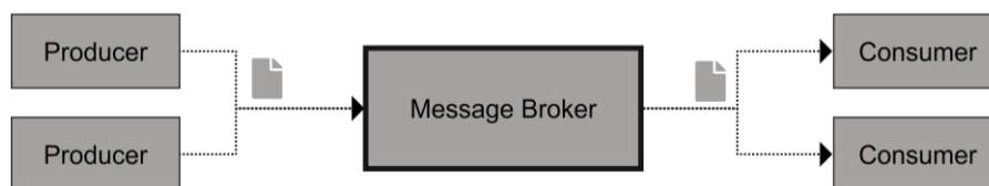
Abbildung 6: Schematische Darstellung eines Message Brokers
