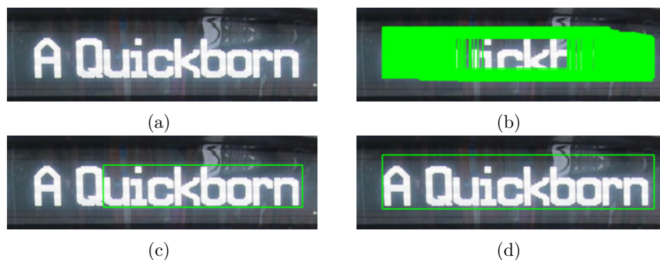
Abbildung 5.21: Texterkennung durch EAST (grüner Rahmen) auf einer (a) Fahrtrichtungsanzeige (b) ohne Weiterverarbeitung, (c) mit Non-Maximum Suppression und (d) über Maximal- und Minimalwerte
