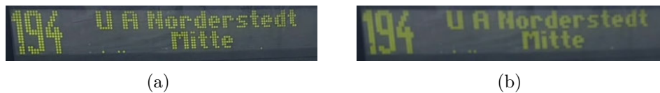
Abbildung 5.13: Beispiel der Skalierung und Weichzeichnung eines zu hoch aufgelösten Bildes (a) in ein für die Texterkennung optimales Bild (b)
