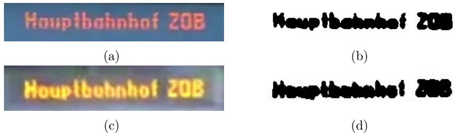
Abbildung 5.24: Binarisierung zweier unterschiedlicher Anzeigen nach Vorverarbeitung mit Otsu-Binarisierung: (a) unbearbeiteter Ausschnitt der ersten Anzeige; (b) binäres Bild der ersten Anzeige; (c) unbearbeiteter Ausschnitt der zweiten Anzeige; (d) binäres Bild der zweiten Anzeige
