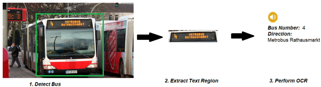
Abbildung 1.1: Idee der Buserkennung und Textklassifikation mit anschließender Ausgabe [34]
