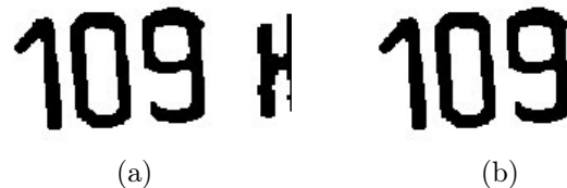
Abbildung 5.31: Nachträgliche Filterung für die Lokalisierung von Ziffern: (a) vorgefiltertes Bild; (b) Filterung von Konturen mit höherer Entfernung zu anderen, mit der zentralen Ziffer verbundenen, Konturen
