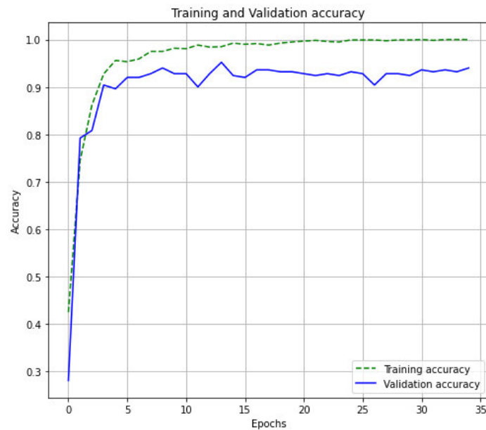
Abbildung 5.7: Training eines voll verketteten neuronalen Netzes mit ReLU- und Softmax-Aktivierungsfunktionen über 35 Epochen
