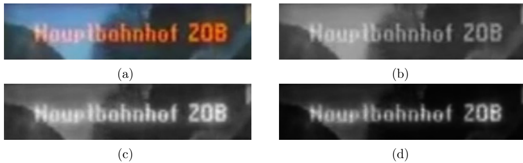
Abbildung 5.17: Filterung der Reflexionen über Auswertung der Farbkanäle bei einer roten Anzeige und klarem Himmel: (a) Originalausschnitt; (b) Bild in Graustufen; (c) roter Farbkanal des Bildes als Grauwert; (d) angepasster roter Farbkanal als Grauwert
