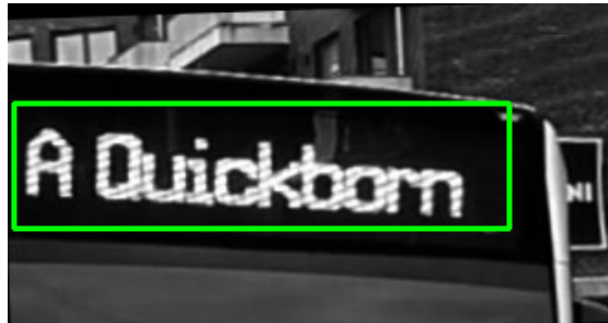
Abbildung 6.2: Text Detektion über EAST (grüner Rahmen) mit nicht optimaler Winkelkorrektur
