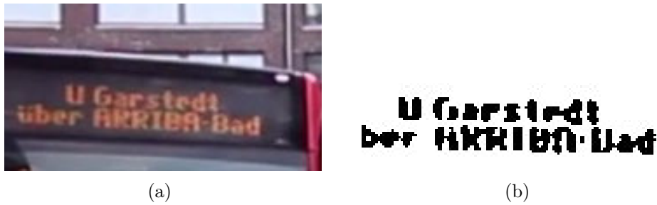
Abbildung 6.4: Fehlerhafte Texterkennung bei geringer Bildqualität: (a) originaler, grober Ausschnitt; (b) verarbeiteter Ausschnitt zu Klassifizierung mit Tesseract
