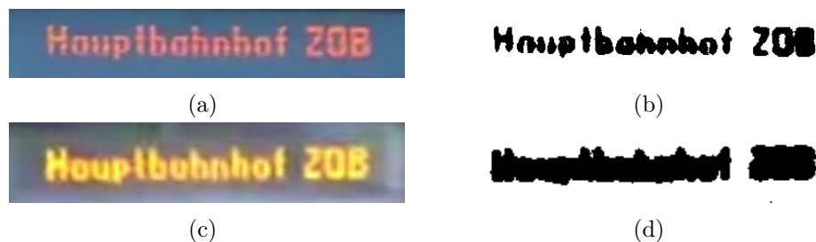
Abbildung 5.23: Binarisierung zweier unterschiedlicher Anzeigen nach Vorverarbeitung mit einem Schwellwert von 150: (a) unbearbeiteter Ausschnitt der Anzeige auf den der Schwellwert angepasst ist; (b) binäres Bild der angepassten Anzeige; (c) unbearbeiteter Ausschnitt einer zweiten Anzeige; (d) binäres Bild der zweiten Anzeige
