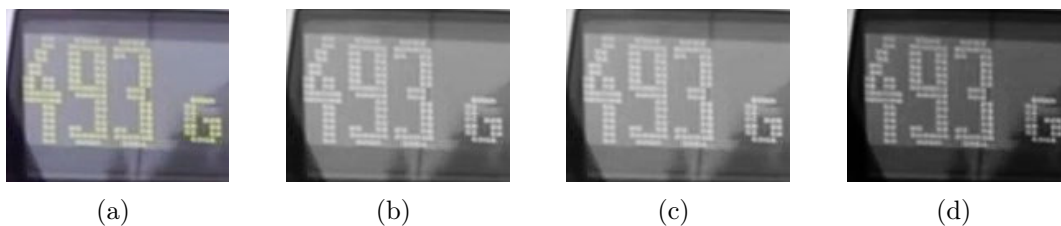
Abbildung 5.18: Filterung der Reflexionen über Auswertung der Farbkanäle bei einer grünen Anzeige und bedecktem Himmel: (a) originaler Ausschnitt; (b) Bild in Graustufen; (c) roter Farbkanal des Bildes als Grauwert; (d) angepasster roter Farbkanal als Grauwert
