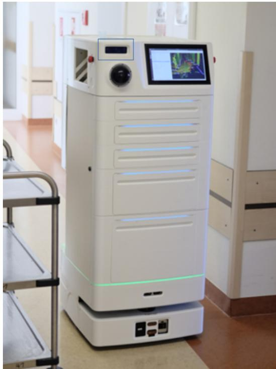
Abbildung 4.1: Roboteraufbau mit markierter OAK-D S2
