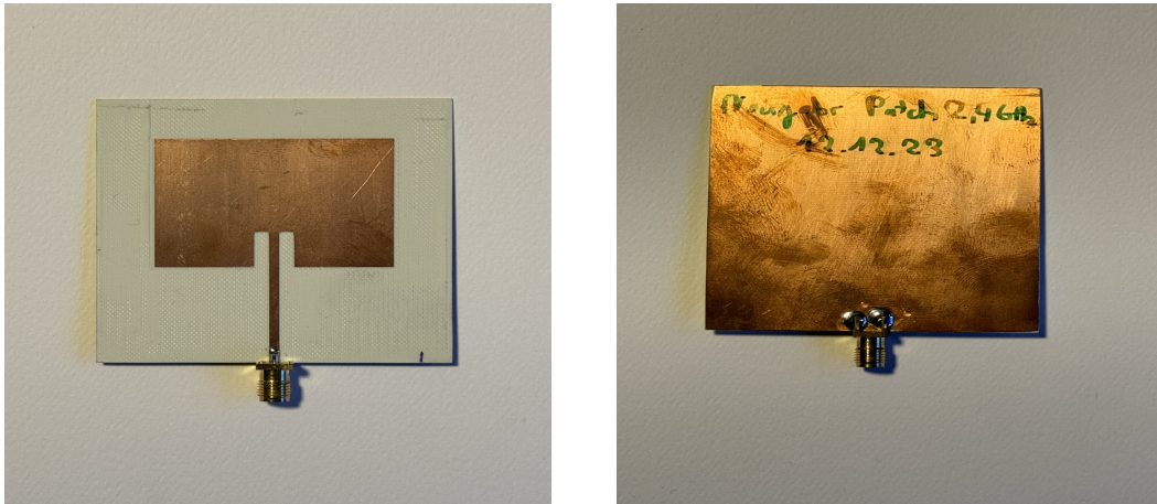
(a) Frontansicht der gefertigten Patchantenne. (b) Rückansicht der gefertigten Patchantenne.
