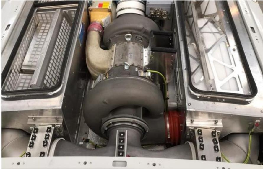
Abbildung 2-25: VMT der ICE3-Kaltluft-Kältemaschine der Firma Liebherr [49]
