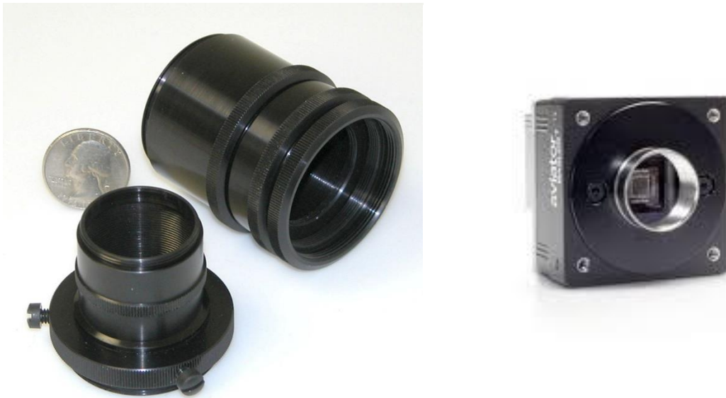
Abbildung 3.16: Camera coupling set (Links) und Basler avA2300-25gm (rechts) [61, 62].
