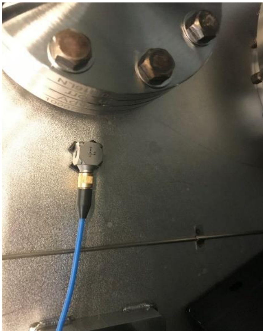
Abbildung 4.5: Sensor in der FFT Kammer.
