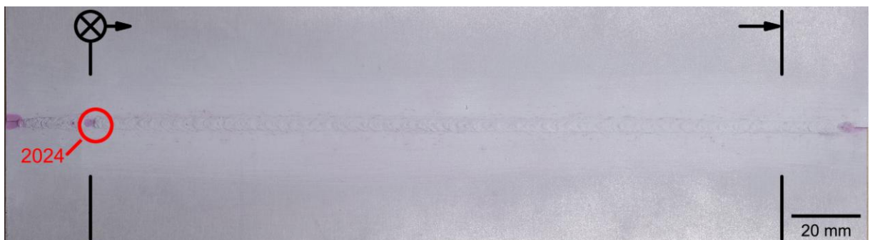
Abb. 40 - Aufnahme der Decklage für die PT-Prüfung (3.3535)
