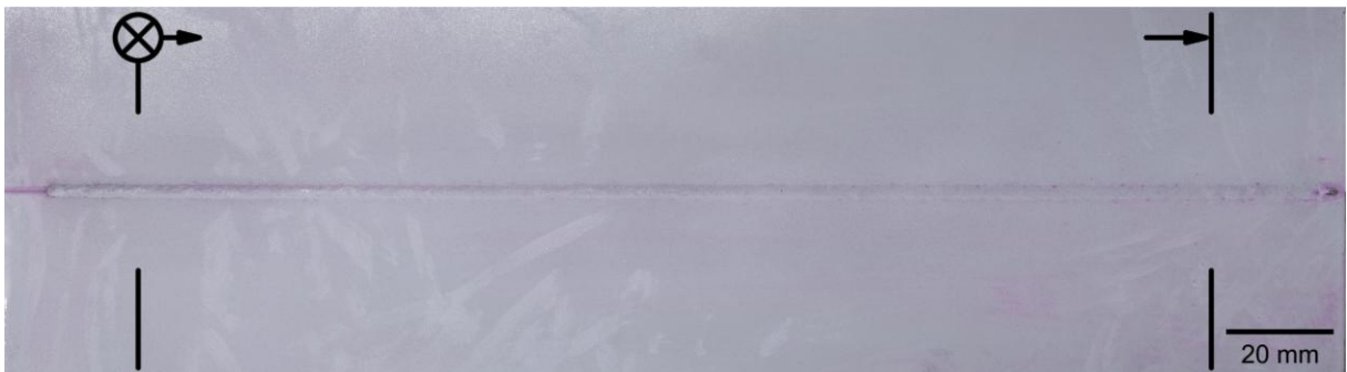
Abb. 33 - Aufnahme der Decklage für die PT-Prüfung (1.4301)
