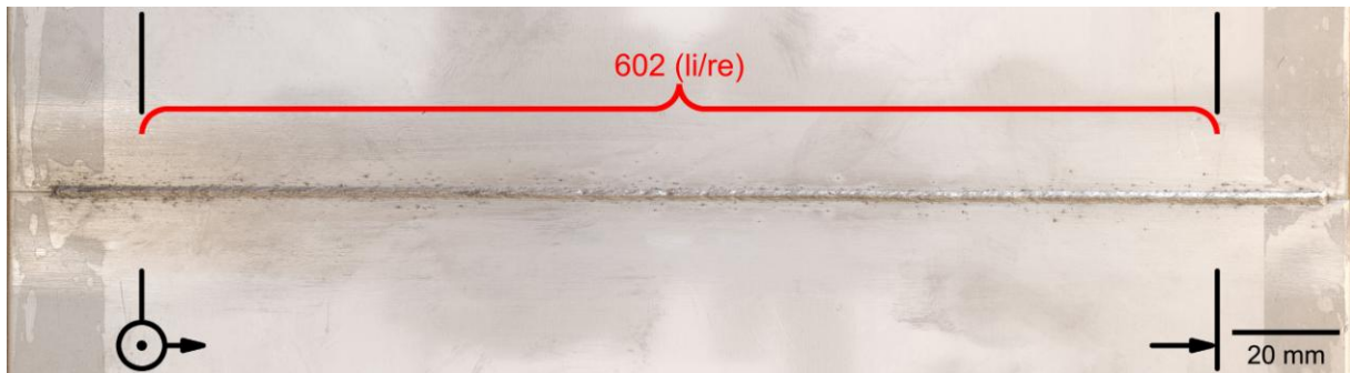
Abb. 32 - Aufnahme der Wurzellage für die VT-Prüfung (1.4301)
