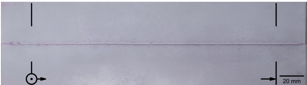
Abb. 34 - Aufnahme der Wurzellage für die PT-Prüfung (1.4301)
