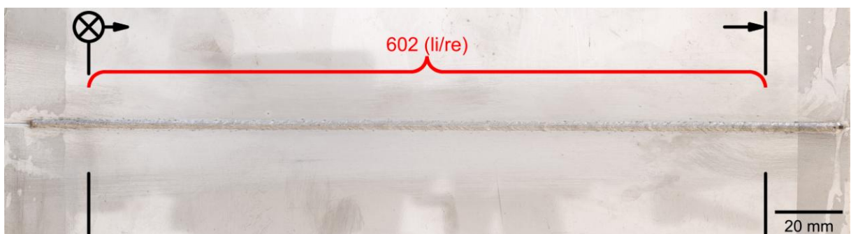
Abb. 31 - Aufnahme der Decklage für die VT-Prüfung (1.4301)
