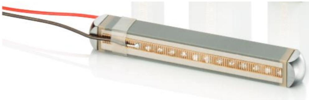
Abbildung 41 Piezoaktor mit Verkabelung [11]
