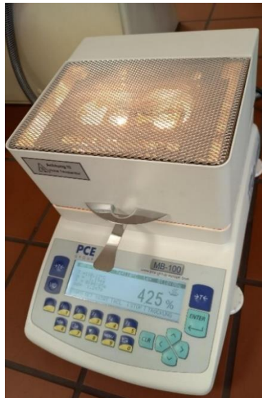
Abbildung 29: Trockenwaage (PCE Group Serie 100) im Betrieb mit Restfeuchteanzeige in Prozent
