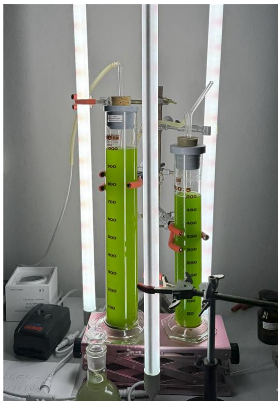
Abbildung 31: Anzucht der Inokulationslösung mit 3 GoLeat LEDs
