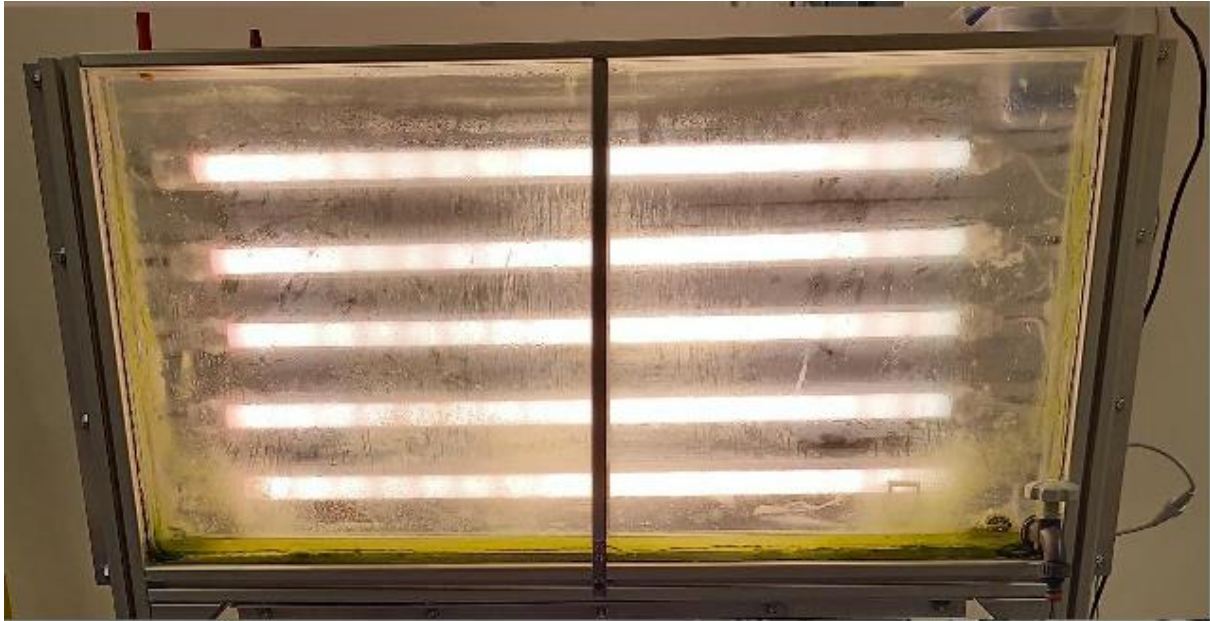
Abbildung 35: Biofouling und Verschmutzung des Photobioreaktors nach Extraktion des Reaktormediums
