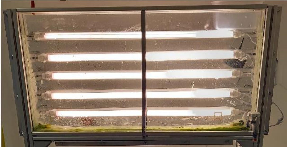
Abbildung 37: Biofouling und Verschmutzung des Bioreaktors nach der Reinigung
