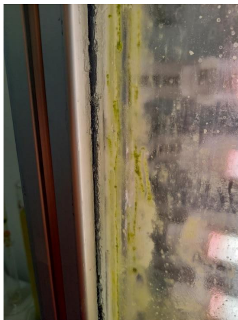
Abbildung 9: Biofouling am Reaktor nach der ersten Versuchsreihe
