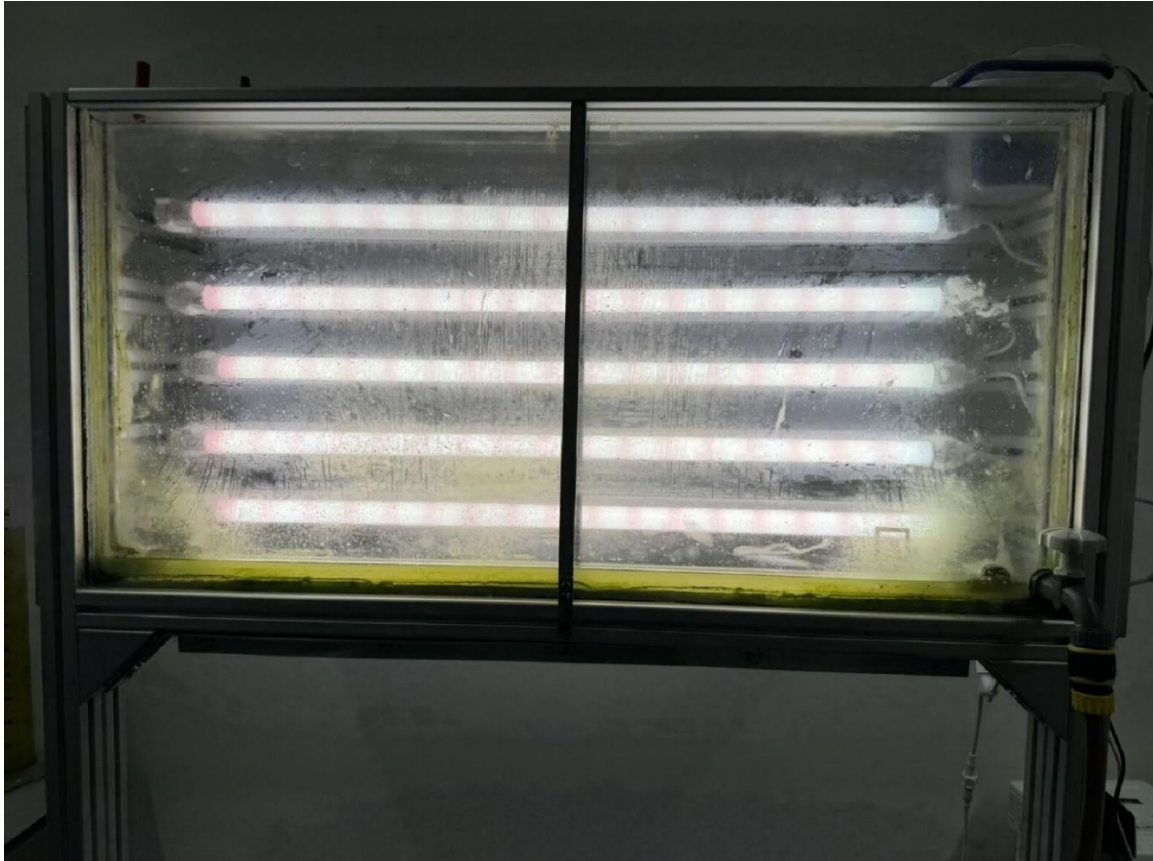
Abbildung 34: Entleerter Photobioreaktor nach dem ersten Versuchsdurchlauf mit deutlichem Biofouling an den Scheiben und Silikon
