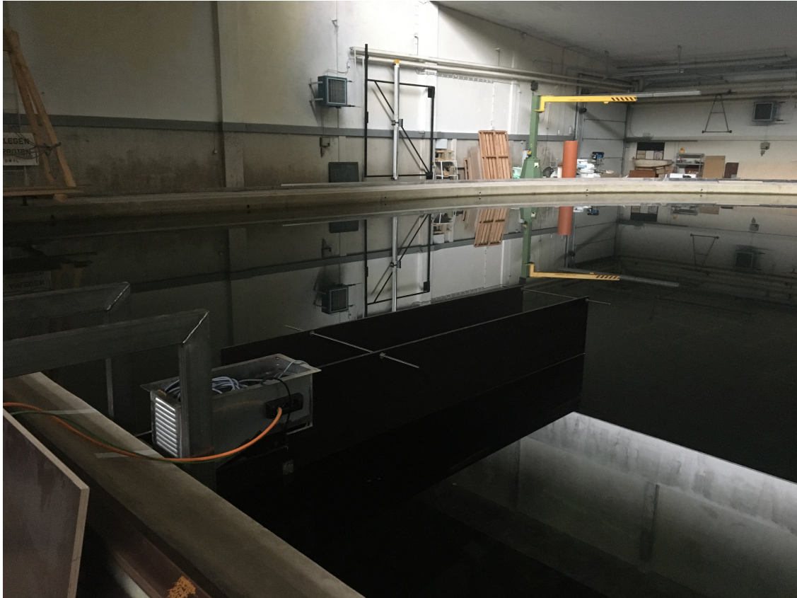
Abbildung 5.3: Eingebaute Testklappe im kleinen Schlepptank der HSVA mit Leitplatten zum Test der Wellenerzeugung
