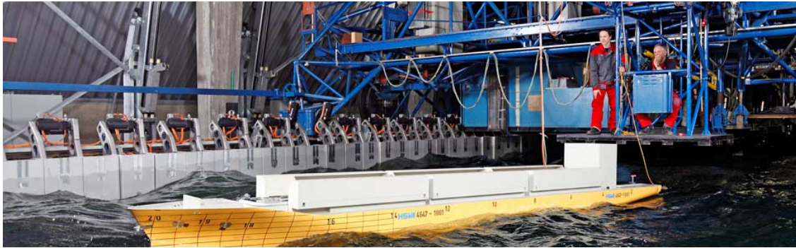
Abbildung 1.1: Beispielhafte Darstellung eines Seegangsversuchs im großen Schlepptank der HSVA [Quelle: HSVA]
