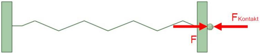
Abb. 2-11: Federbeispiel Gegenkraft [28]
