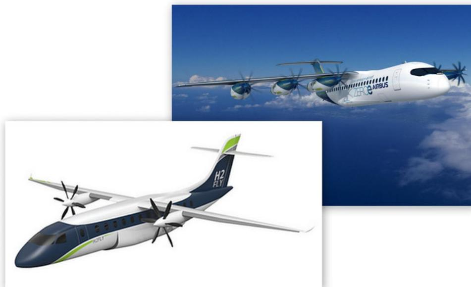
Abbildung 1.2: Die geplante Wasserstoffvariante der Do328 (H2FLY 2022) und das Propellerflugzeug der AIRBUS ZEROe-Reihe (AIRBUS 2020)
